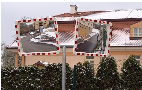
Návrh řešení umístění dvou ks dopravních zrcadel na jednom sloupku pomocí ocel. pozinkovaného držáku dvou zrcadel
